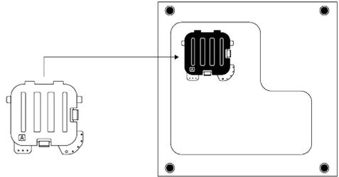
稍微向後傾斜洗衣機。將蓋板 A 的卡舌靠在下面板上。旋轉蓋板完成組裝。
